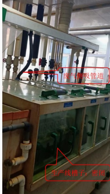
图 7.1-2 蚀刻线废气收集示意图
