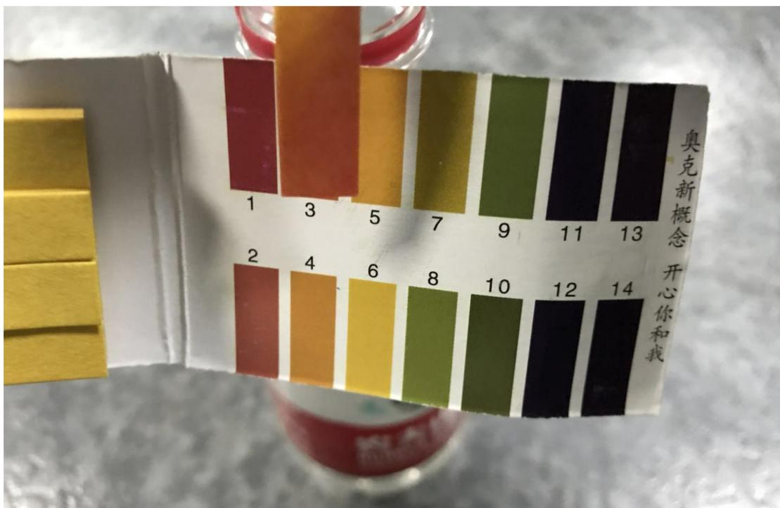
(图6 理士电池疑似偷排废水 pH 试纸检测值呈强酸性)
